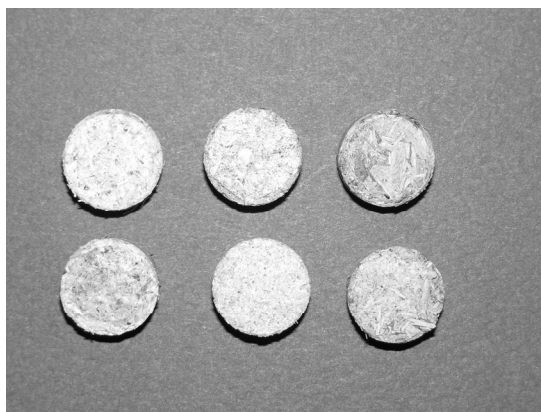
Сл. 2. Изглед на таблети за испитување на содржината на пепел, сулфур и горна топлотна моќ кај брикети изработени од различна сировина
